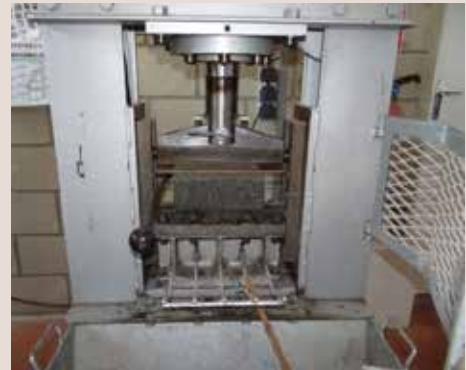
Essai de résistance mécanique : fendage sur pavé
